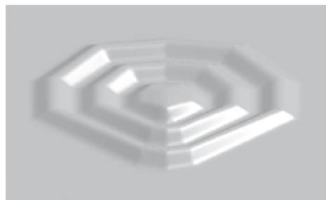
図7 ホイールハウスインナーの最適化された予成形形状 B Fig. 7 Preformed model B (Optimized shape) before main forming of wheel house inner
